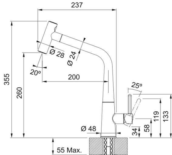
Mit ihrem modernen Design und wunderbaren Funktionen ist Icon die perfekte Balance von Ästhetik und Funktionalität. Entscheiden Sie sich für die Icon-Auszugsdüse mit Doppelstrahlbrause und Neoperl-Laminar-Strahlregler für weniger Wasserspritzer. Oder wählen Sie den Schwenkauslauf Icon mit praktischem, ergonomischem Front-Bedienhebel für viel beschäftigte oder schmutzige Hände.
