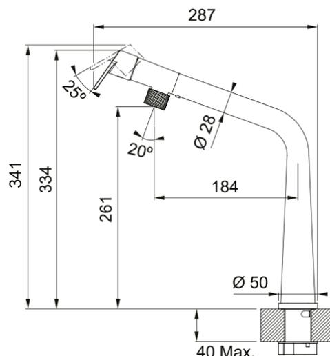
Mit ihrem modernen Design und wunderbaren Funktionen ist Icon die perfekte Balance von Ästhetik und Funktionalität. <br>Entscheiden Sie sich für die Icon-Auszugsdüse mit Doppelstrahlbrause und Neoperl-Laminar-Strahlregler für weniger Wasserspritzer. Oder wählen Sie den Schwenkauslauf Icon mit praktischem, ergonomischem Front-Bedienhebel für viel beschäftigte oder schmutzige Hände.
