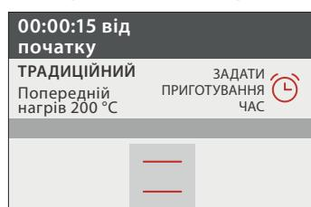
Після завершення цієї фази пролунає сигнал, і на дисплеї з'явиться повідомлення про те, що духовна шафа досягла встановленої температури.
