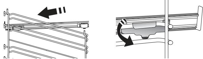
Upozornění: Posuvné drážky lze nainstalovat do kterékoli úrovně.
