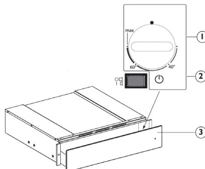
Ovládacími prvky jsou ovladač teploty a vypínač zapnutí/vypnutí s kontrolkou.
