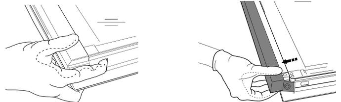
2. Sollevare e prendere saldamente il vetro interno con due mani, rimuoverlo e appoggiarlo su un piano morbido prima di eseguire la pulizia.
