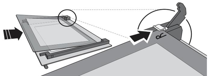
4. Zamontować ponownie górną krawędź: charakterystyczne kliknięcie sygnalizuje prawidłową pozycję. Przed ponownym założeniem drzwiczek należy sprawdzić, czy uszczelka jest zabezpieczona.
