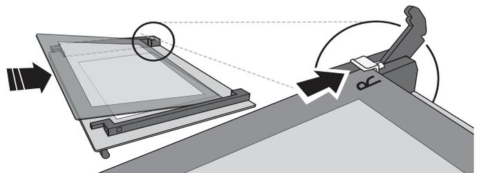
4. Remplacez le bord supérieur: un déclic indique qu'il est bien placé. Assurez-vous que le joint est bien placé avant de remonter la porte.
