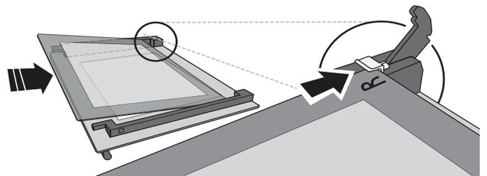
4. Namontujte horní lištu: zacvaknutí indikuje správnou montáž. Před nasazením dvířek zkontrolujte těsnění.
