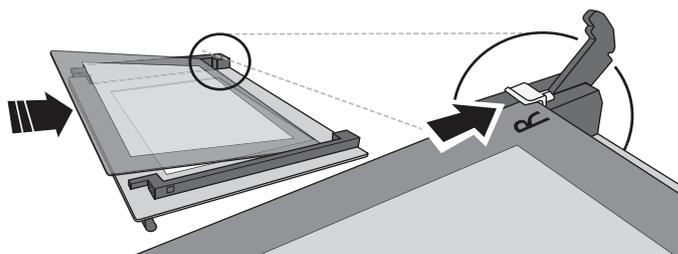
4. Montați la loc marginea superioară: Poziționarea corectă se realizează după ce se aude un clic. Asigurați-vă că garnitura este fixată sigur înainte de a remonta ușa.
