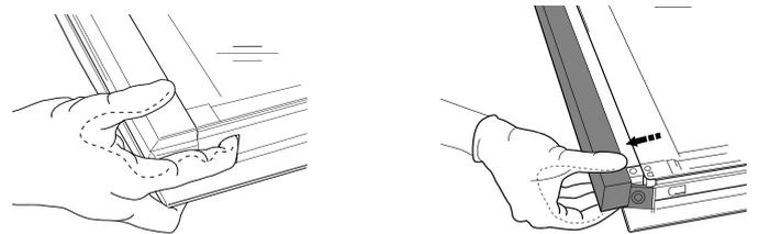
2. Levante e segure firmemente o vidro interior com ambas as mãos, removendo-o e colocando-o sobre uma superfície suave antes de proceder à sua limpeza.
