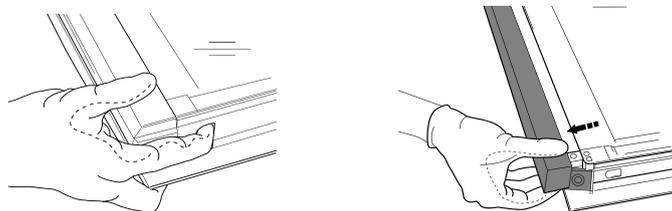
2. Ridicați și țineți ferm cu ambele mâini geamul interior, demontați-l și amplasați-l pe o suprafață moale înainte de a-l curăța.
