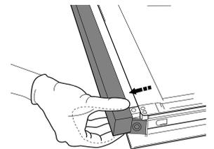
2. Zvedněte a pevně držte vnitřní sklo oběma rukama, přeneste sklo na měkký povrch. Poté začnete s čištěním.
