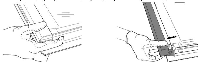
2. Σηκώστε και κρατήστε σταθερά το εσωτερικό τζάμι και με τα δύο χέρια, αφαιρέστε το και τοποθετήστε το σε μια μαλακή επιφάνεια πριν το καθαρίσετε.
