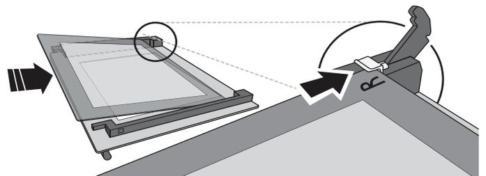
4. Vuelva a colocar la parte superior: un clic le indicará que se ha colocado correctamente. Asegúrese de que el precinto esté asegurado antes de volver a montar la puerta.
