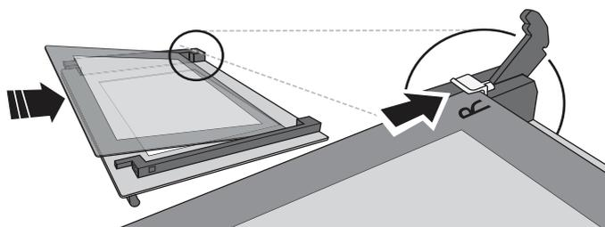
4. Επανατοποθετήστε την άνω γωνία: ένα κλικ δείχνει ότι τοποθετήθηκε σωστά. Βεβαιωθείτε ότι η τσιμούχα είναι καλά σταθεροποιημένη πριν επανατοποθετήσετε την πόρτα.
