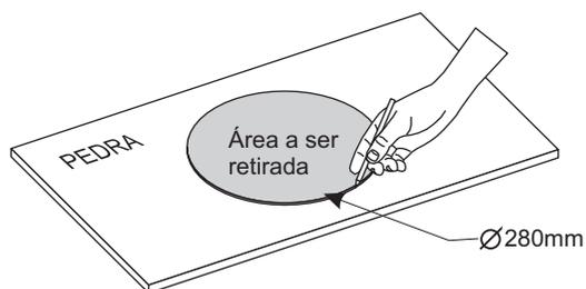
A dimensão do corte com os recuos nas partes frontal e dos fundos da pedra, deverão seguir as dimensões mínimas ilustradas abaixo.
