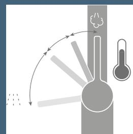
Retirer le levier et tourner la bague à l'intérieur pour limiter la température de départ\*
