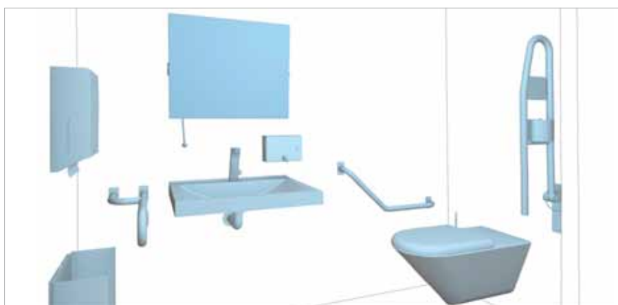
CABINĂ DE WC ADAPTATĂ PERSOANELOR CU DIZABILITĂȚI: dispenser prosoape de hârtie, coș de gunoi, oglindă rabatabilă, mâner de sprijin cu montare pe perete, chiuvetă individuală, armătură cu senzor, dozator de săpun, mâner lateral de perete 135°, WC cu scaun adaptat persoanelor cu dizabilități, mâner de perete rabatabil cu activarea tragerii apei
