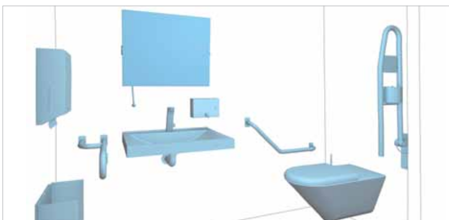
BEHINDERTENGERECHTE WC-KABINE: Papierhandtuchspender, Abfallbehälter, Kippspiegel, Wandstützgriff, Einzel-Waschbecken, Sensor-Armatur, Seifenspender, Seitenwandgriff 135°, Behindertengerechtes WC mit Sitz, Wandklappgriff mit Spülbetätigung
