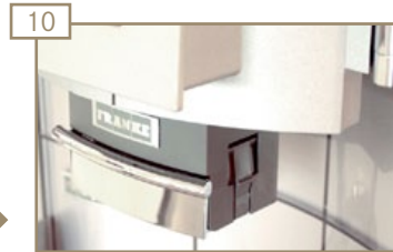
10 Auslaufkopf in Kaffeemaschine einsetzen und verriegeln. Die Laschen müssen bündig sitzen.
