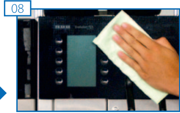
Evolution Plus und Zusteilgerätee mit einem feuchten Mikrofaser-tuch reinigen.
