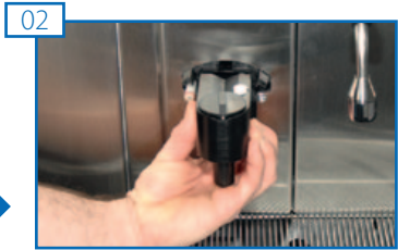
Schäumerkopf entfernen, falls vorhanden.
