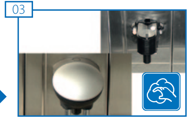
Schäumerkopf und Kaffeeauslauf mit mildem Reinigungsmittel reinigen.
