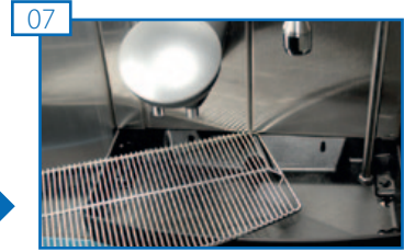
Tropfgitter und Tropfschale reinigen.
