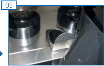
Reinigungstablette in den Pulvereinwurf einwerfen.
